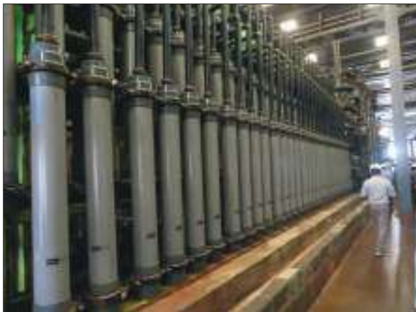
Figure 10.21: UF Membranes Skids
