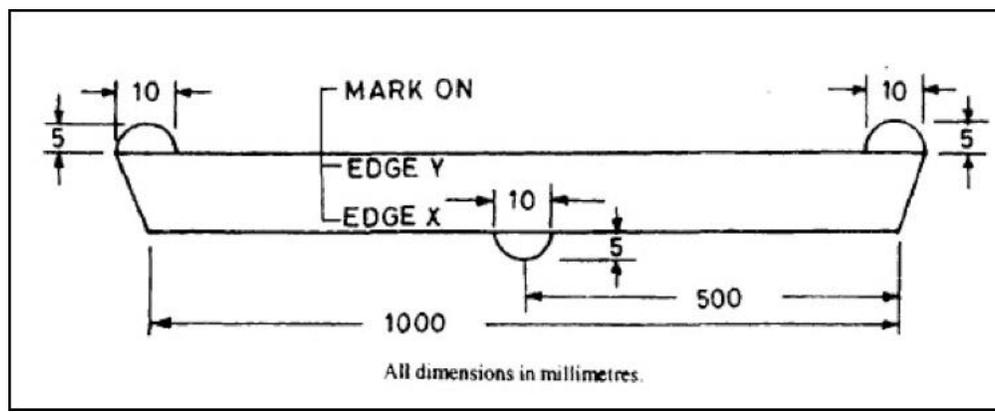
FIG :13 STRAIGHTNESS TEST
